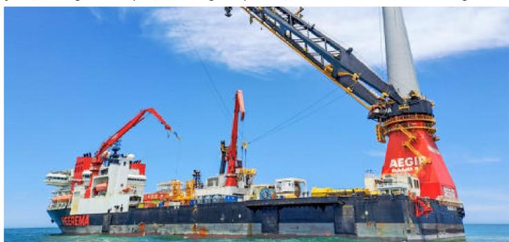
llevará a cabo con seis embarcaciones simultáneas equipadas con sistemas de posicionamiento dinámico y tecnología de inteligencia artificial. La estructura se fijará al suelo marino mediante el hincado y cementación de pilotes para garantizar estabilidad.
