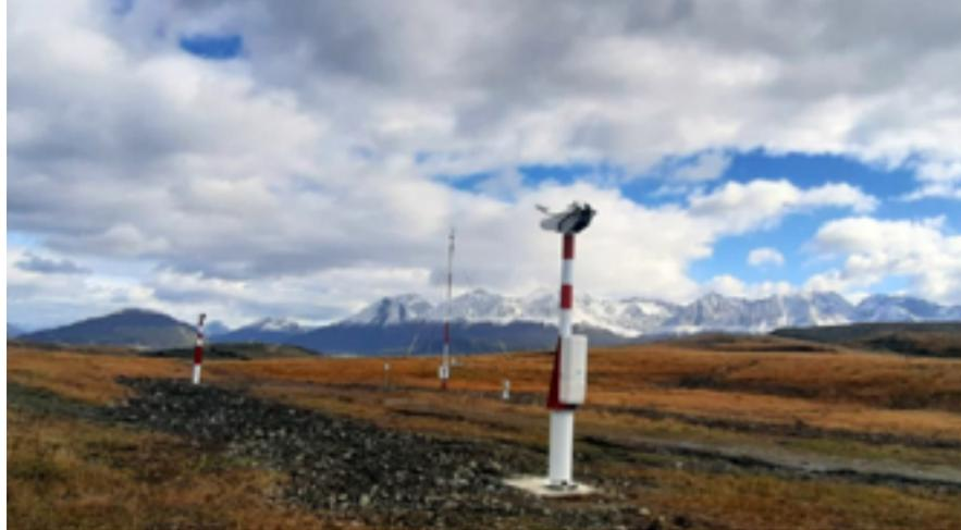
visibilidad menor a la necesaria hasta el momento en ambos aeropuertos. Esto se debe a que los AWOS transmiten de manera automática y en tiempo real, datos de alta precisión sobre las condiciones meteorológicas en determinados puntos de la pista.
